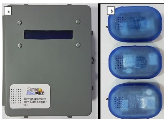
Figura 4 – Imagens dos termohigrômetros alternativos prontos.
