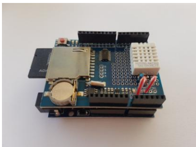
Figura 3 – Imagens da montagem dos termohigrômetros.
