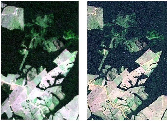
Figura 3. a) Imagem multiespectral (4,3,2) com 30 metros. b) Imagem fusionada com resolução de 15 metros. Fonte: INPE.
