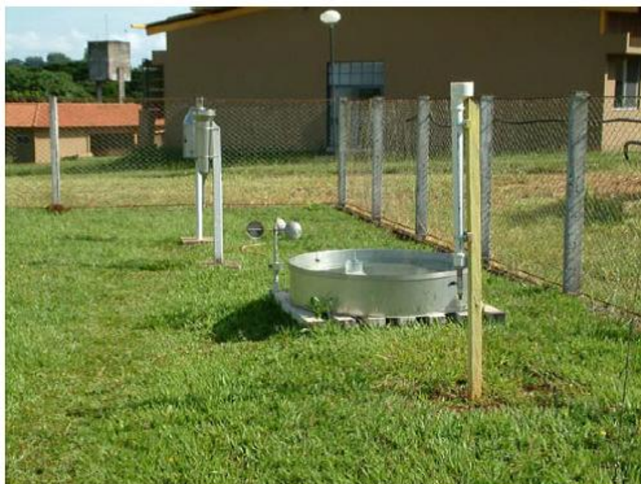
Figura 6 Processo de aferição e calibração do pluviômetro de baixo custo, 2018.
