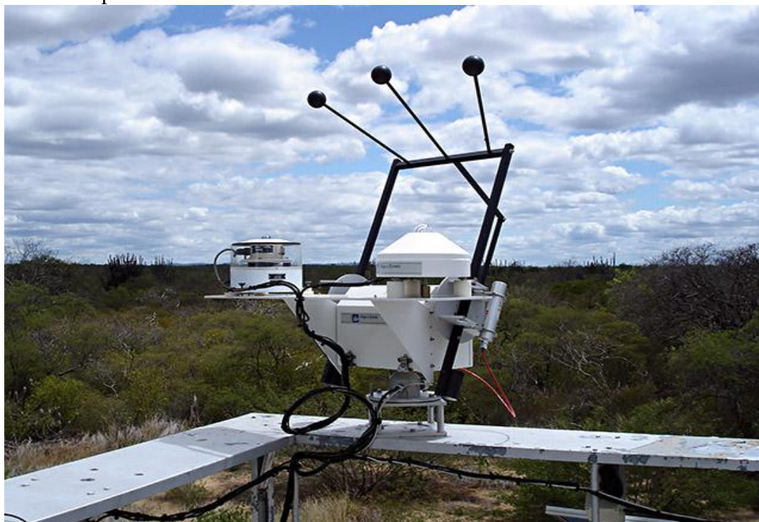
Figura 2. Vista do rastreador solar da estação meteorológica de Petrolina, com os três rastreadores solares: o pirgeômetro, o piranômetro e o pireliômetro.
