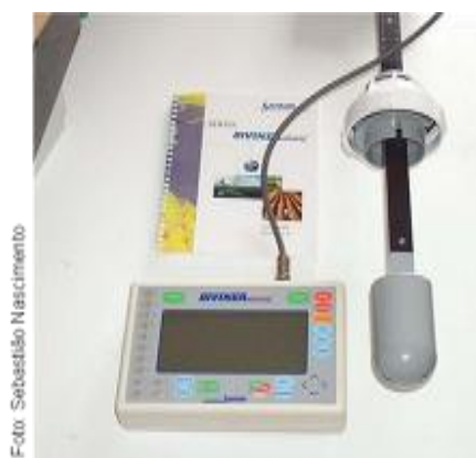
Figura 3. Equipamento DIVINER 2000 – Sentek utilizado no monitoramento do teor de água no solo, mede a umidade do solo a cada 10 cm.
