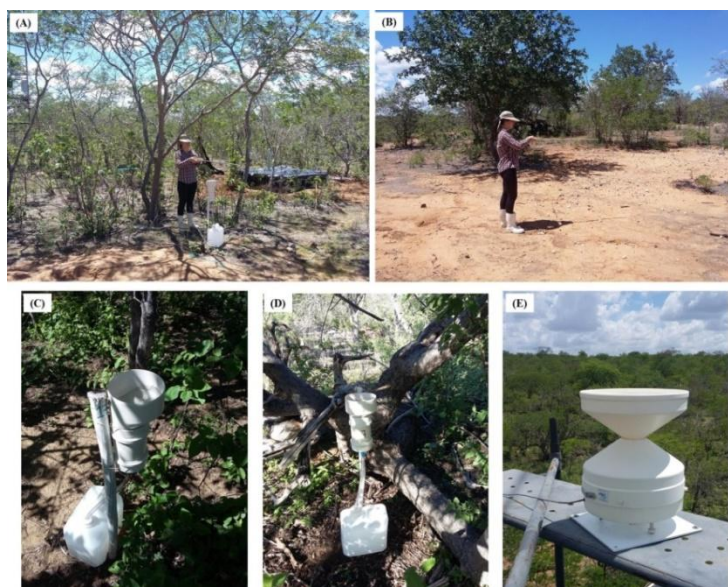
Figura 1. Obtenção de medições de Índice de cobertura vegetal, precipitação interna e externa: (A) Leitura de RFA incidente; (B) Leitura de RFA transmitida; (C e D) Pluviômetros internos; (E) Pluviômetro externo.
