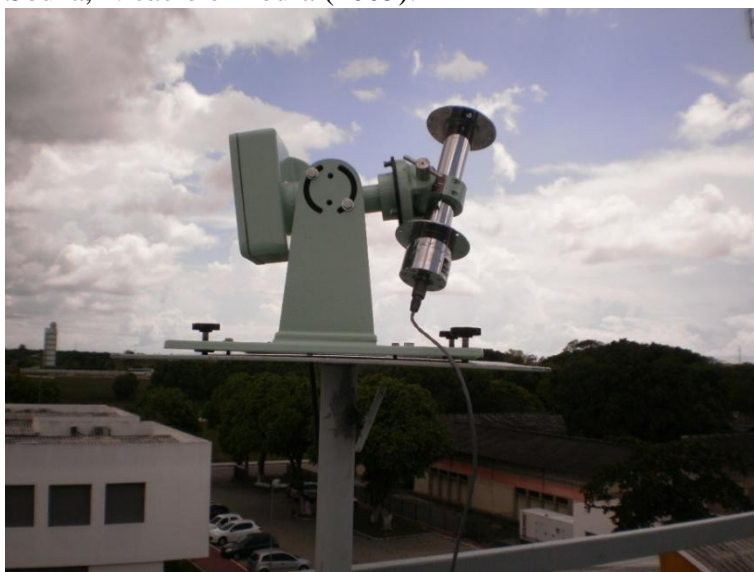
Figura 1. Pireliômetro utilizado para a medição da irradiância solar direta sobre o telhado do prédio Severinão, na Universidade Federal de Alagoas (UFAL) em Maceió-AL ( 9^{\circ} 33' S , 35^{\circ} 46' O , 100 m).
