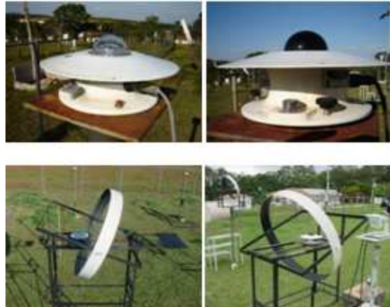
Figura 1 Piranômetros Eppley PSP medindo as radiações globais e piranômetros Eppley PSP com anéis de sobreamento medindo as radiações difusas.
