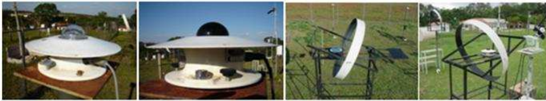
Figura(1) piranômetros Eppley PSP medindo as radiações global e piranômetros Eppley PSP com anéis de sobreamento medindo as radiações difusa.
