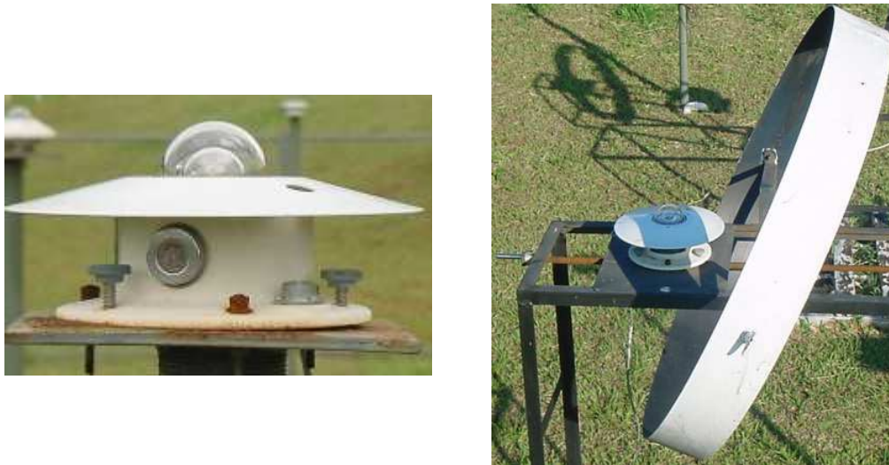
Figura 1. Sensores utilizados na medida das irradiâncias solares global e difusa.
