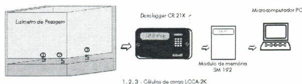
Figura 1 - Esquema de funcionamento e coleta de dados do lisímetro de pesagem
