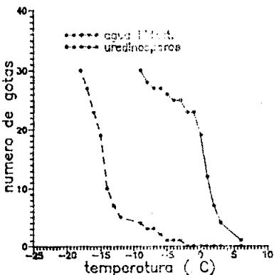
As temperaturas apresentadas referem-se às medidas efetuadas visualmente do termômetro imerso em água/etanol dentro da câmara e portanto indicam valores mais quentes que a da superfície de contato das gotículas. Entretanto estes valores relativos entre o controle e o experimento refletem a importância nucleadora do soluto.
