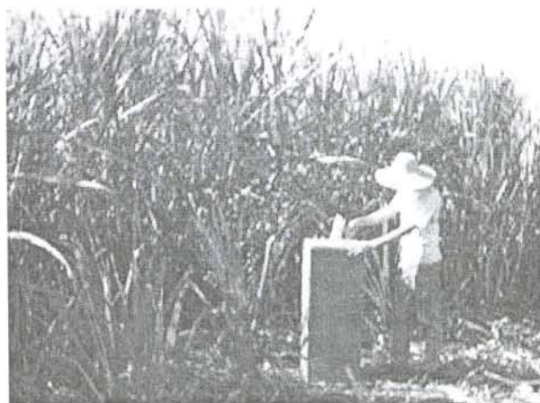
Figura 4. Medição de temperatura radiativa de uma amostra de cana rearranjada no solo sendo feita com a caixa pelo "método de uma tampa".
