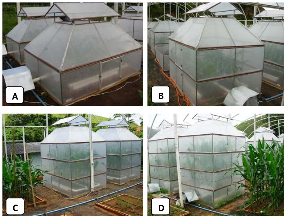
Figura 2 – Câmaras de topo aberto com acréscimo dos módulos para acompanhar o crescimento e desenvolvimento das plantas: A - Câmaras com um módulo; B - Câmaras com dois módulos; C - Câmaras com três módulos; e D - Câmaras com quatro módulos.
