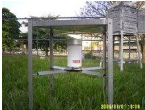
Figura 3 – Modelo proposto de sistema “automatizado” para ser utilizado em estudos de interceptação em ecossistemas florestais.
