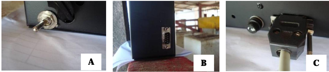
Figura 2. Chave liga/desliga (A), entrada RS232 (DB 9) para programação (B) e comunicação RS232 (DB 15) com os sensores.
