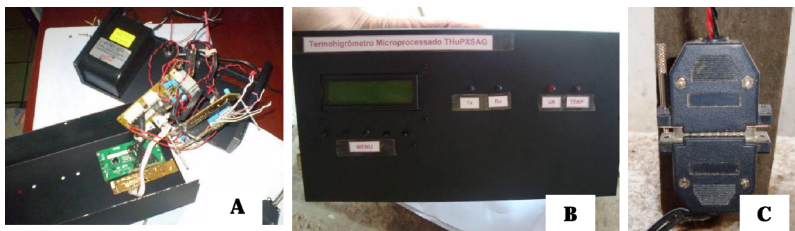
Figura 1. Montagem do controlador (A), vista frontal do controlador (B), conector DB 25 para comunicação entre o controlador e os atuadores.
