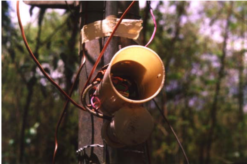
Figura 1. Aspecto do psicrômetro, notando-se a posição dos termopares e do “cooler”, bem como do reservatório de água destilada.
