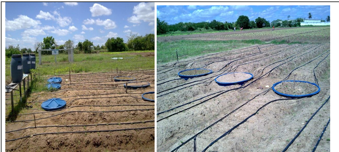
Figura 1 - Lisímetros de lençol freático constante instalado na área experimental de Itabaiana-SE.
