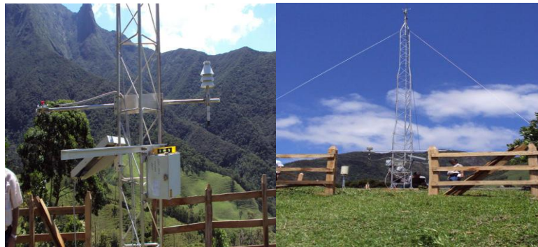
Figura1: Plataforma de Coleta de Dados instalada no Pico dos Marins.
