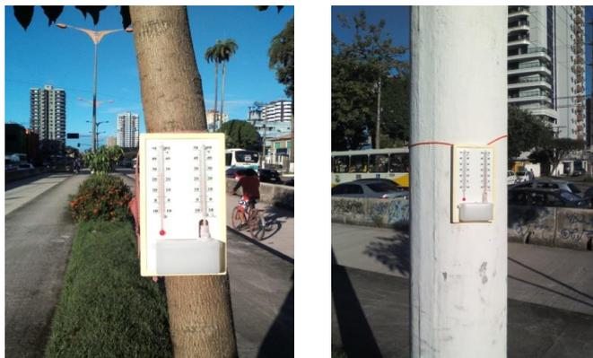
Imagem 3 e 4 - Termo-higrômetros posicionados no canteiro central da Av. Almirante Barroso, sob a árvore e ao poste de iluminação respectivamente
