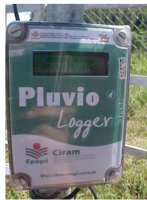
Figura 4. Estação pluviométrica automática (pluviologger)
