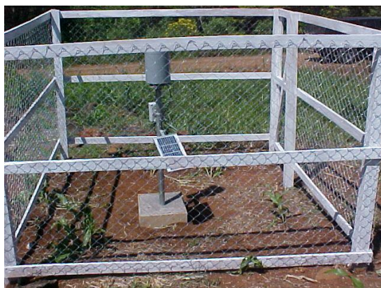
Figura 3. Estação completa: pluviômetro de balsa, logger e painel solar, no cercado.
