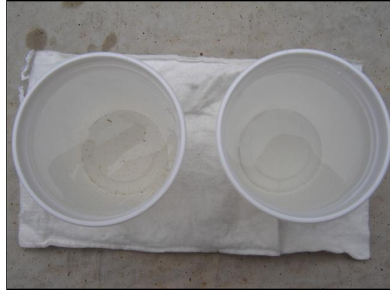
Figura 2. Aspectos da qualidade da água na microbacia da Concórdia, Lontras. A esquerda, aspecto da água ao entrar no sistema de zona de raízes e, a direita a água na saída.
