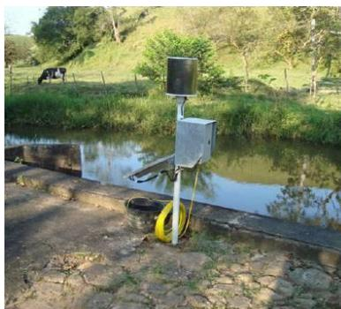
**Figura 1:** Estação hidrológica automática instalada na sede da Companhia de Saneamento do Estado de Sergipe (DESO).
