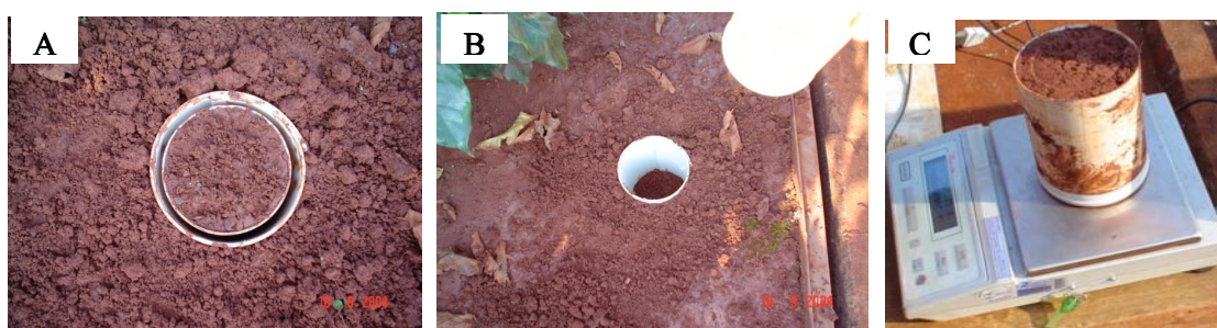
Figura 1. Microlisímetro instalado (A), detalhe da estrutura externa (B) e pesagem (C).
