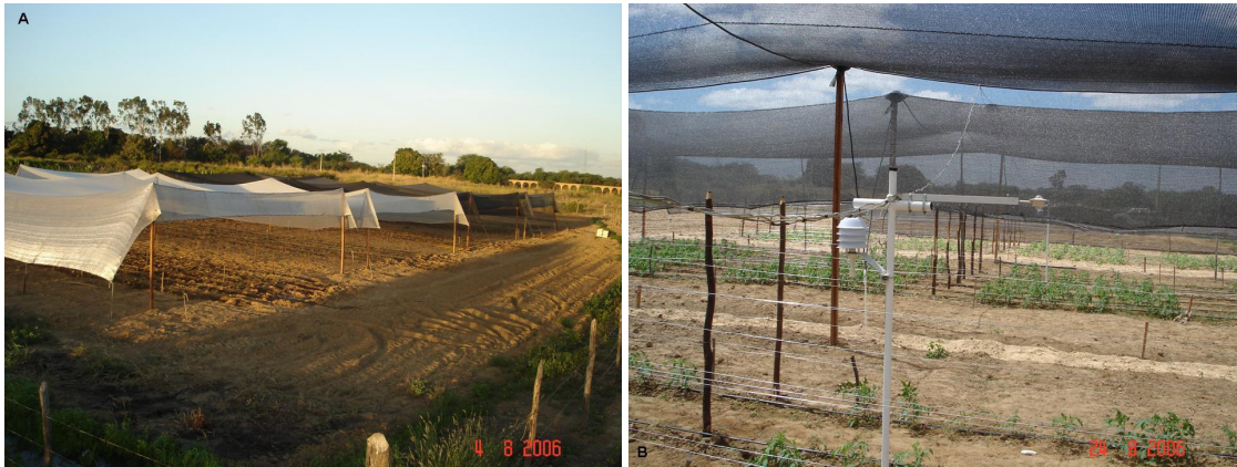
Quadro 1. (a) Coberturas: Aluminet, polisombra branco, polisombra preto e cromatinet difusor. (b) Sensores de temperatura do ar e radiação solar.
