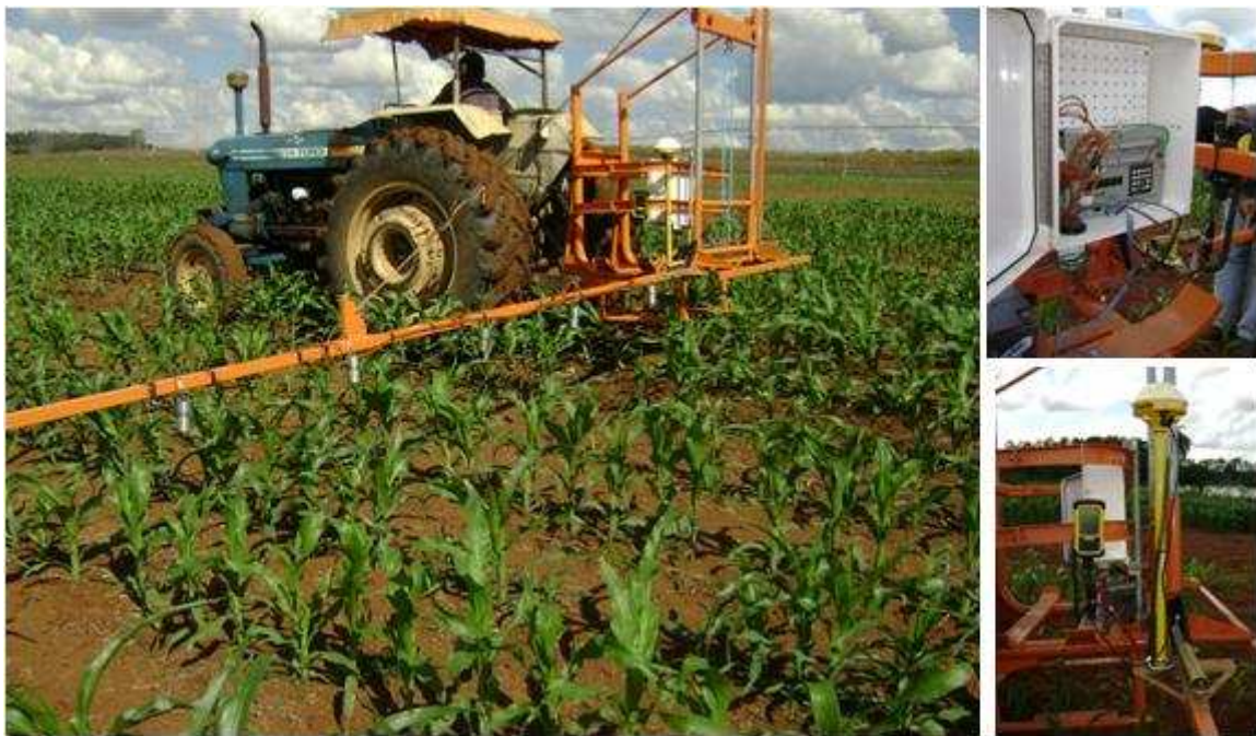
Figura 2. Sistema modular mecanizado de aquisição de temperaturas do dossel de culturas anuais, constituído de transdutores digitais de temperatura a infravermelho (TDTIV), uma plataforma automática de aquisição de dados (Campbell Scientific, CR23X), um sistema diferencial de posicionamento global (DGPS, Trimble, AG 114) e um chassi de uma barra de um pulverizador (Jacto), acoplados ao engate de três pontos de um trator (Fotos Reinaldo Gomide, Embrapa Milho e Sorgo, Sete Lagoas, MG, 2009).
