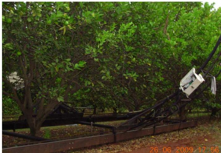
Figura 1 - Vista lateral do sistema de amostragem de  $R_n$ , composto de um arco de medida e um trilho para deslocamento.
