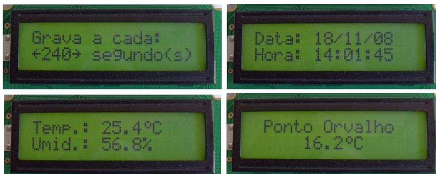
Figura 3. Visor de LCD. Intervalo de aquisição, data e hora, temperatura, umidade relativa e temperatura de ponto de orvalho.
