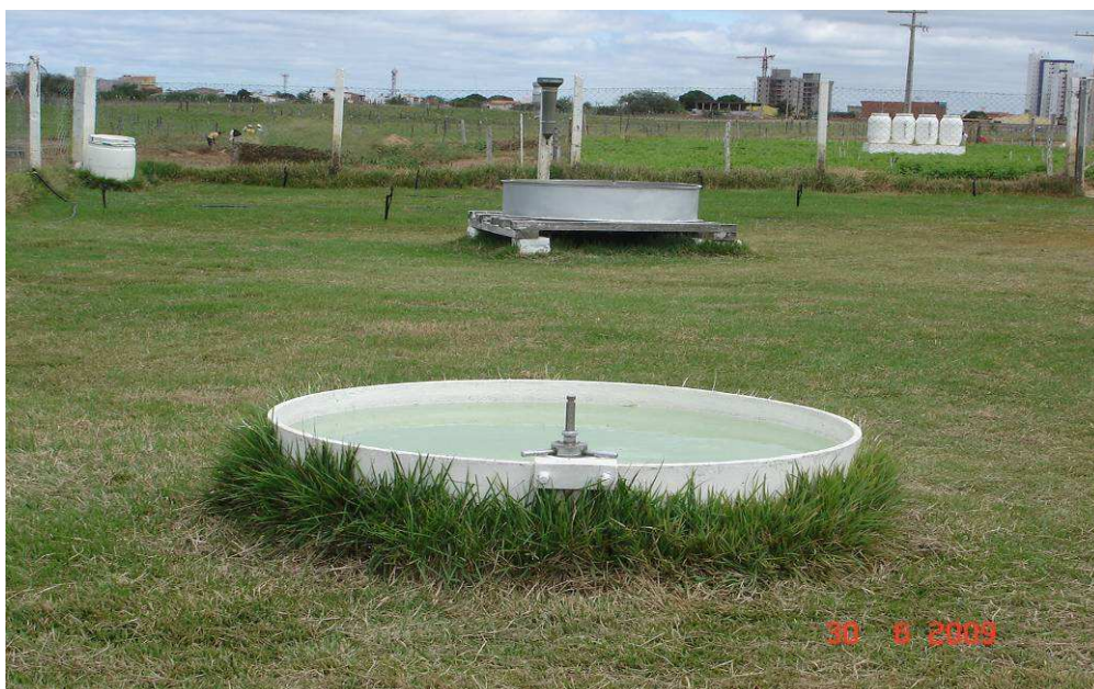
Figura 1. Localização dos tanques classe A e cimento amianto na estação meteorológica.
