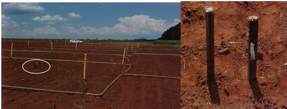
FIGURA 5. Instalação dos termômetros na linha e entrelinha, em área irrigada, sob preparo do solo com escarificador.
