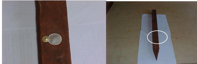
FIGURA 4. Acoplamento dos termômetros em estacas de madeira.
