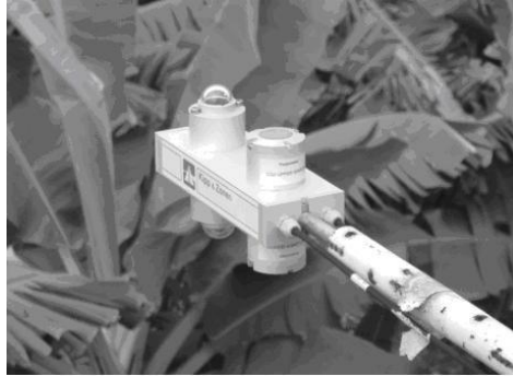
Figura 2: Saldo radiômetro instalado sobre o dossel da bananeira na área experimental.
