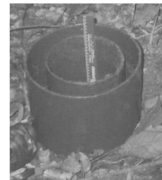
Figura 1. Infiltrômetro por inundação.
