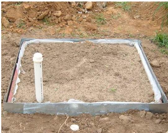
Figura 2. Vista do lisímetro totalmente preenchido com solo e detalhe das chapas laterais utilizadas como acabamento.
