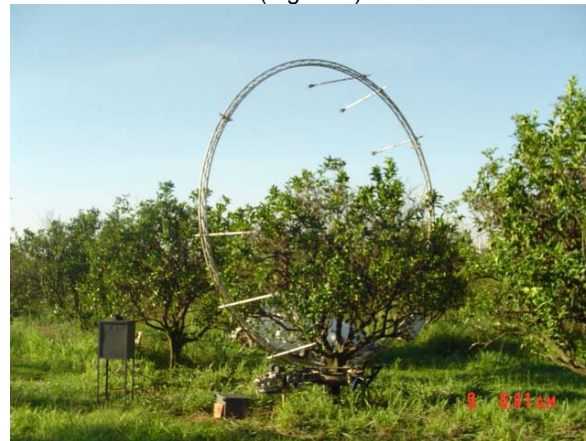
Figura 1. Sistema integrador do saldo de radiação para plantas isoladas em pomar de laranjeiras.
