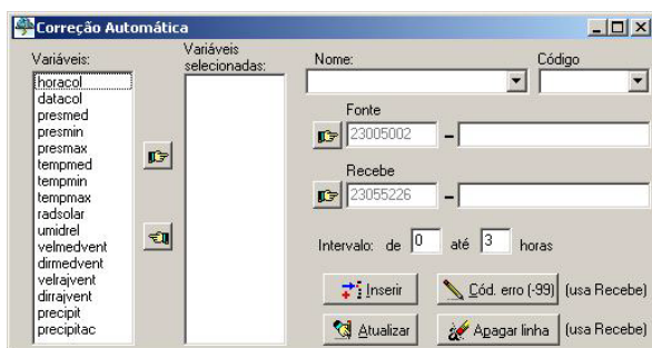
Figura 5. Esta interface corrige automaticamente os dados que foram importados e estão sendo exibidos na figura 2 como possíveis erros. Os métodos de correção são: inserir código de erro do sistema; inserção ou atualização utilizando uma estação próxima; correção manual.
