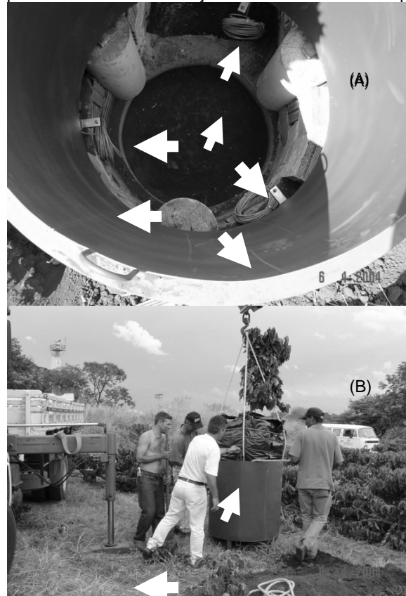
Figura 1. (A) - Célula de carga em formato de “viga” fixadas (veja as setas) na base do tanque e (B) - transplante do monólito com cafeeiro de 3 anos.
