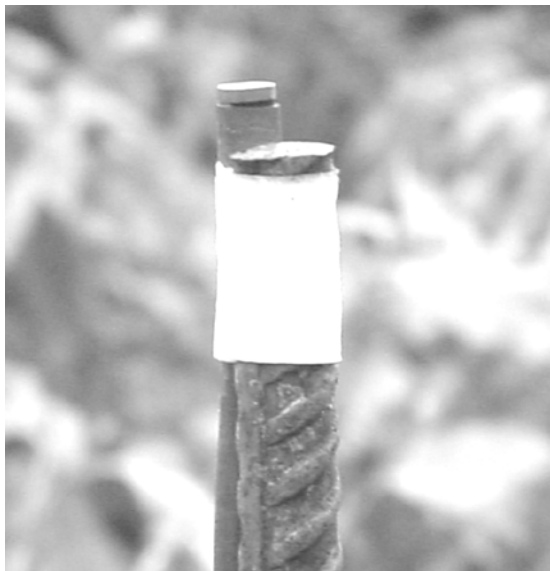
Figura 2. Quantômetro instalado no campo, fixado a uma barra de ferro com fita adesiva.
