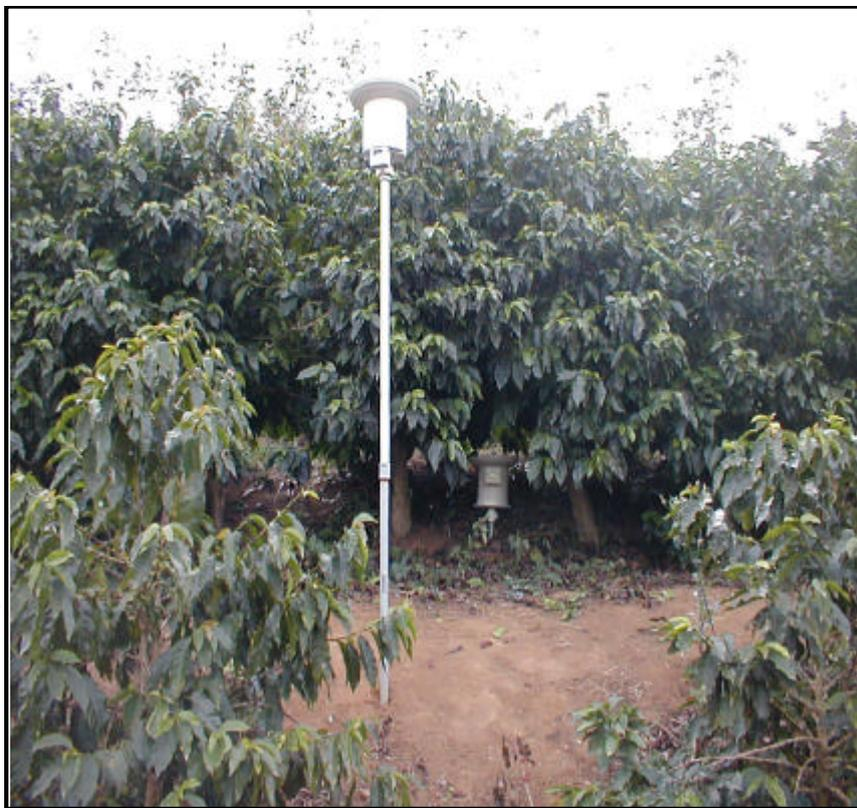
**Figura 1.** Modelo de coletor utilizado no monitoramento do total precipitado e throughfall.
