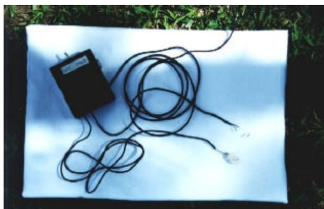
Figura 4 Sensores de temperatura e umidade relativa conectados ao BSII embutido na caixa de baquelite preta.
