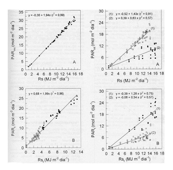
Figura 2. Relação entre  $PAR_{inc}$  e Rs (A) e entre PAR e Rs em uma comunidade de alfafa (B), para o período de 26 de abril a 1º de julho de 1995, em Eldorado do Sul – RS. Símbolos vazados representam IAF superior à 1,5 e cheios IAF inferior a esse limite.
