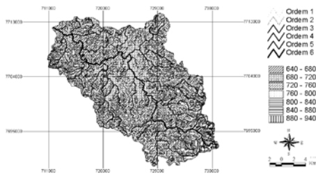
Figura 2. Sobreposição da hidrografia sobre os intervalos de curvas de níveis da bacia hidrográfica do rio Turvo Sujo, micro-região de Viçosa, MG.
